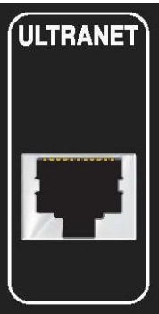
퍼스널 모니터링 시스템(예 : 베링거 P16)을 이더넷 케이블로 연결합니다.
